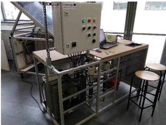
Figuur 1: Meettoestel om warmteafgifte van buizen te meten (links) en meetopstelling van de metingen in gecontroleerde omstandigheden (rechts)
