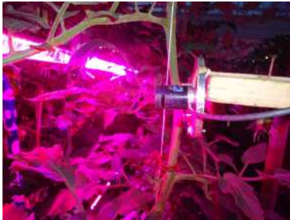
Foto 2 Het licht van de LED toplight modules werd gemeten door de sensor horizontaal te houden (rechts). Voor het licht van de LED interlight modules werd de sensor verticaal gedraaid (links).
