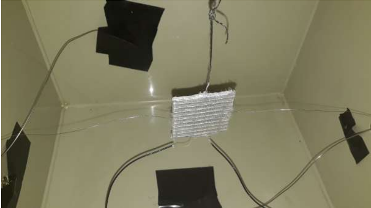
Fig. 1 Foto van vacuümbox test setup voor het meten van de stralingseigenschappen van schermen
